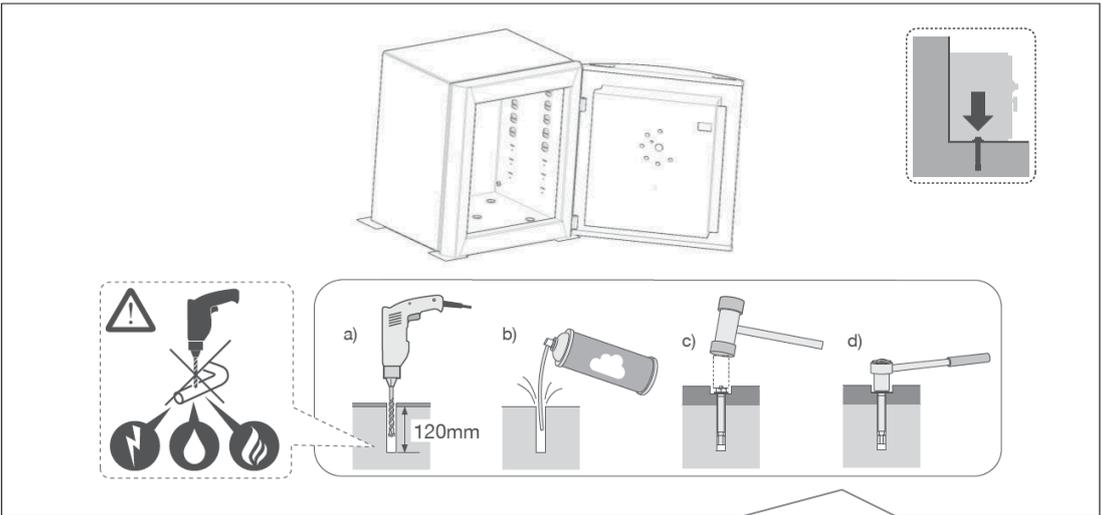
FR Pour une fixation conforme aux normes, le coffre doit être fixé avec la cheville fournie, et dans un support béton présentant une compression de 250 MPa en appliquant un couple de serrage de 150 Nm.
